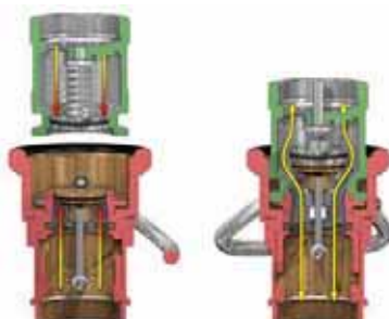
Pour déconnecter Tourner et tirer Déconnexion terminée Pas de fuite
